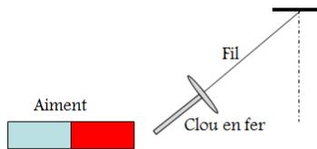
On compare entre l'action exercée par le fil sur le clou et celle exercée par l'aimant sur le même clou
